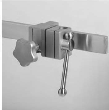
19799-02 Klemmsocle aus rostfreiem Stahl, für ein höhenverstellbares Stativ Ø 16 mm, elektrisch isoliert bis 1,5 kV AC, Spannweite 35 mm für Schienen 25/32 x 8/12 mm. Clamp socket made of stainless steel, for height-adjustable stand Ø 16 mm, electrically insulated up to 1.5 kV AC, holding width of 35 mm for rails 25/32 x 8/12 mm.
