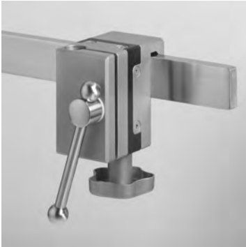
19799-01 Klemmsocle aus rostfreiem Stahl, für ein höhenverstellbares Stativ Ø 16 mm, elektrisch isoliert bis 1,5 kV AC, Spannweite 35 mm für Schienen 25/32 x 8/12 mm. Clamp socket made of stainless steel, for height-adjustable stand Ø 16 mm, electrically insulated up to 1.5 kV AC, holding width of 35 mm for rails 25/32 x 8/12 mm.
