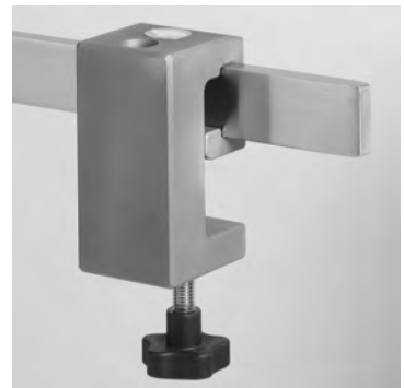
19799-06 Leichtmetall-Klemmsocle Spannweite 50 mm, für ein Schraubstativ mit Ø 16 mm/M10, für Schienen 25/35 x 8/10 und Rohre Ø 12 - 35 mm. Clamp socket made of light metal, holding width 50 mm, for screw stand Ø 16 mm/M10, for rails 25/35 x 8/10 and tubes Ø 12 - 35 mm.
