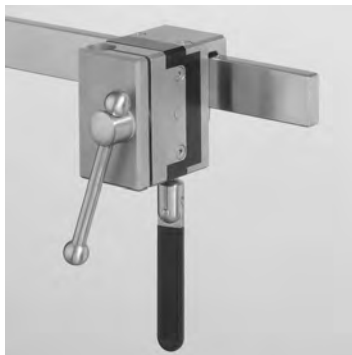
19799-05 Klemmsocle aus rostfreiem Stahl, für ein höhenverstellbares Stativ Ø 16 mm, elektrisch isoliert bis 4,5 kV AC, Spannweite 50 mm für Schienen 25/32 x 8/12 mm. Clamp socket made of stainless steel, for height-adjustable stand Ø 16 mm, electrically insulated up to 4.5 kV AC, holding width of 50 mm for rails 25/32 x 8/12 mm.
