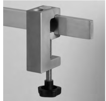
19799-03 Leichtmetall-Klemmsocle Spannweite 35 mm, für ein Schraubstativ mit Ø 16 mm/M10, für Schienen 25/35 x 8/10 und Rohre Ø 12 - 35 mm. Clamp socket made of light metal, holding width 35 mm, for screw stand Ø 16 mm/M10, for rails 25/35 x 8/10 and tubes Ø 12 - 35 mm.
